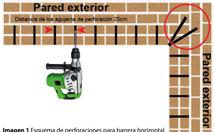
Imagen 1 Esquema de perforaciones para barrera horizontal
